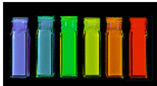
Figure 11 : Qdots en solution, éclairés par une source de lumière unique. Une large palette de couleurs peut être obtenue en faisant varier la taille des particules.
